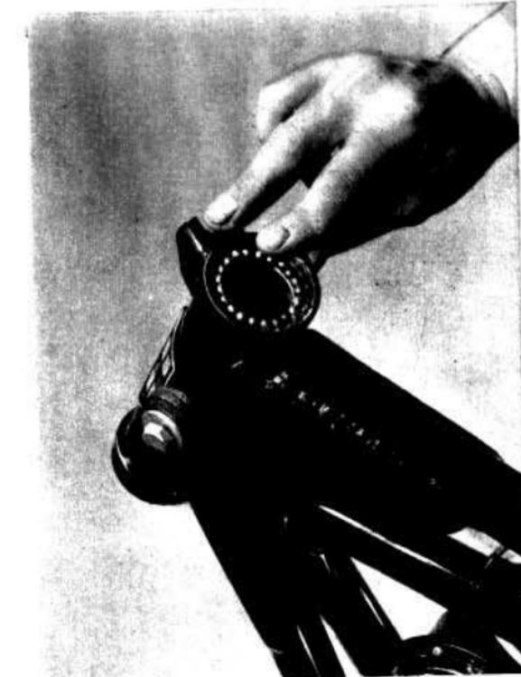
Рис. 61. Консистентная смазка подшипника руля
