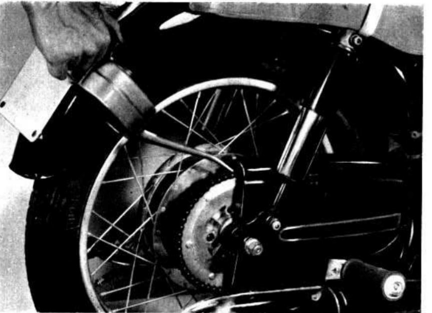
После каждого 800—1000 км советуем ослабить два болта запорной части заднего кожуха цепями и после снятия полукруговой запорной части при двигателе поднятием на колесную станину медленным поворачиванием тщательного омывать каждое звено цепи кистью с керосином, после этого способом, указанным на рис. 45, также медленным поворачиванием тщательно смазывается маслом обе стороны цепи, там, где скобы присоединяются друг к другу.
