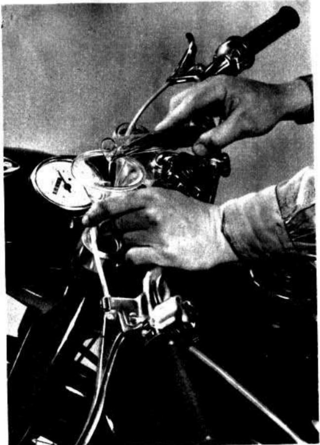
Рис. 60. Пополнение масла в передней вилке
